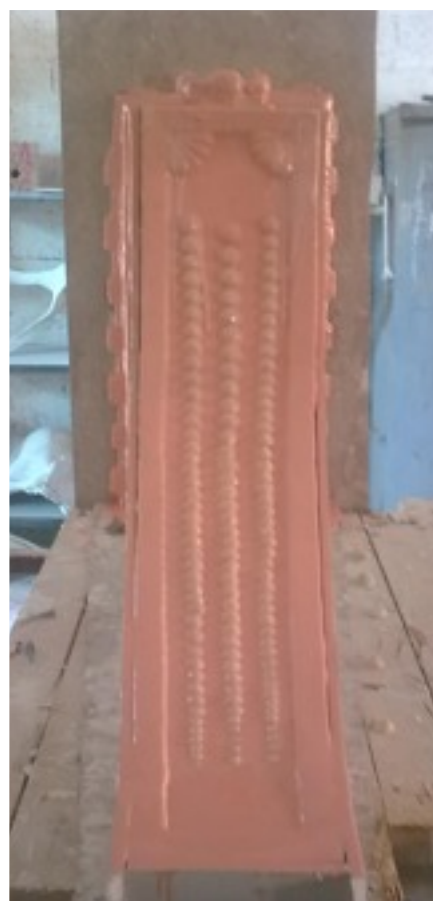
4. שיעתוק הקורה הכנת התבנית מגומי סיליקון rtv וגב ויציקת הקורה החדשה
